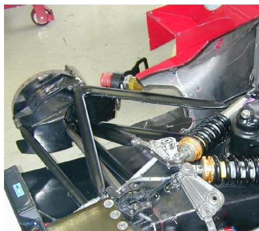
Obr.10 Okamžitý tangenciálny skrutkový pohyb nosiča predného 5 prvkového zavesenia kola vo F1 so skrutkovou osou o_\omega , ktorá je osou riadenia.
